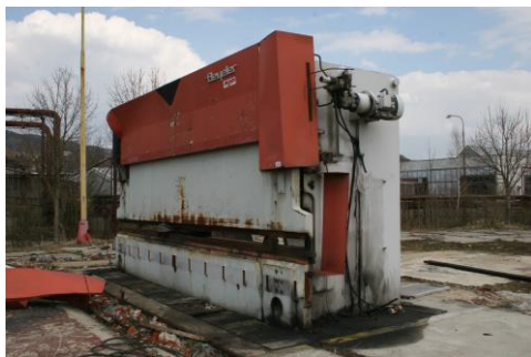
LIS OHRANOVACÍ BEYLER 1500 KNx6200 mm
