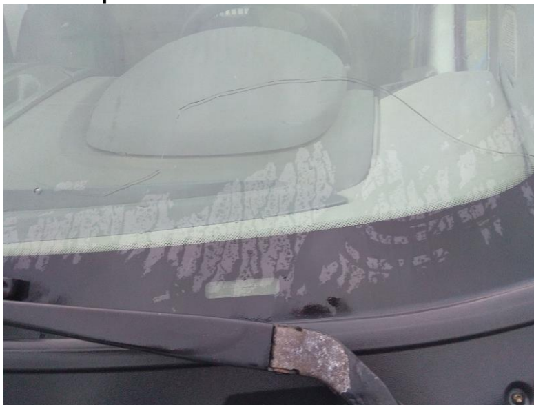
foto č.3 - poškození čelního skla
