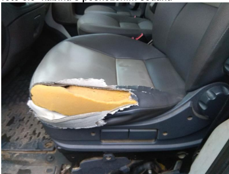
foto č.5- kabina s poškozením sedáku
