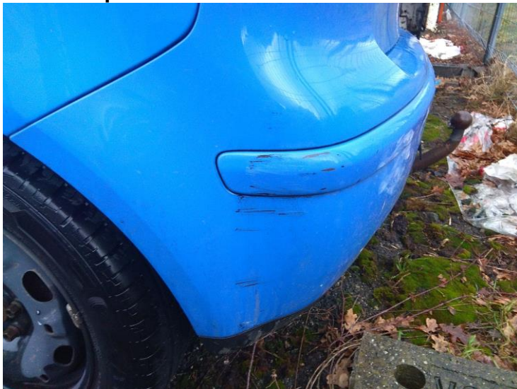
foto č.4 - poškození - zadní levá část nárazníku
