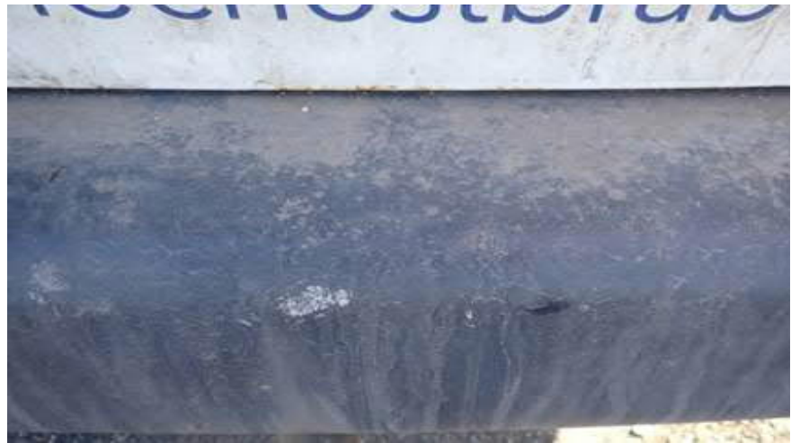
koroze zadních dveří a poškozen zadní nárazník
