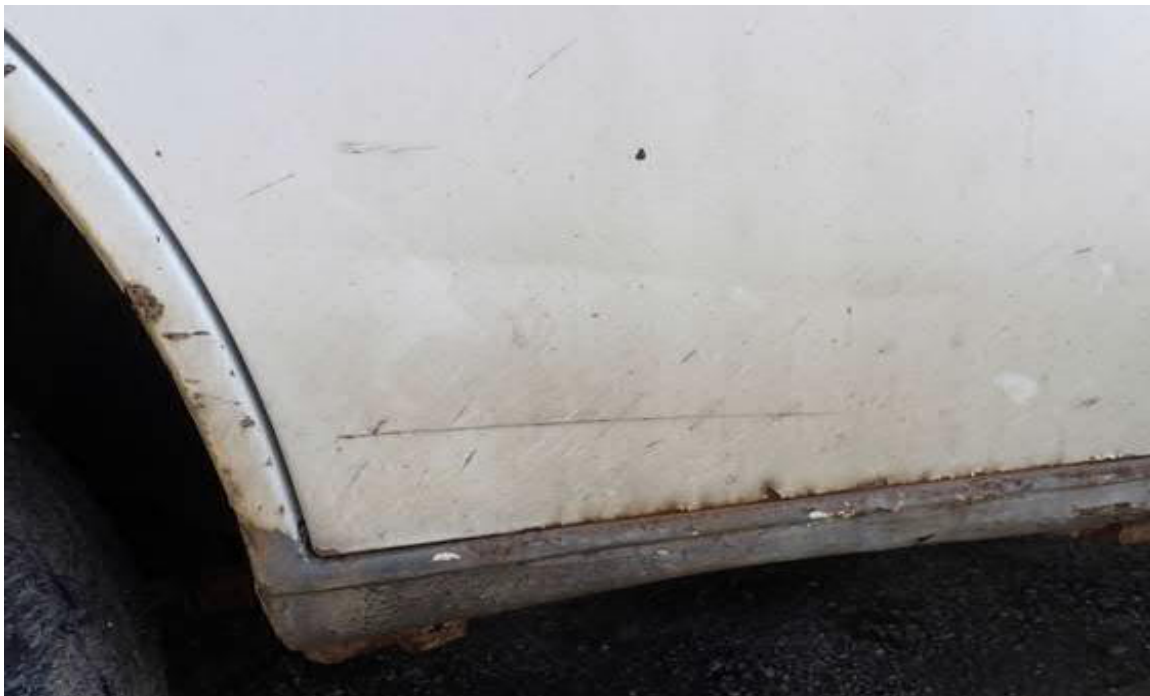
levé přední dveře zkorodovány-poškozeny, levý práh a levý přední blatník zkorodován
