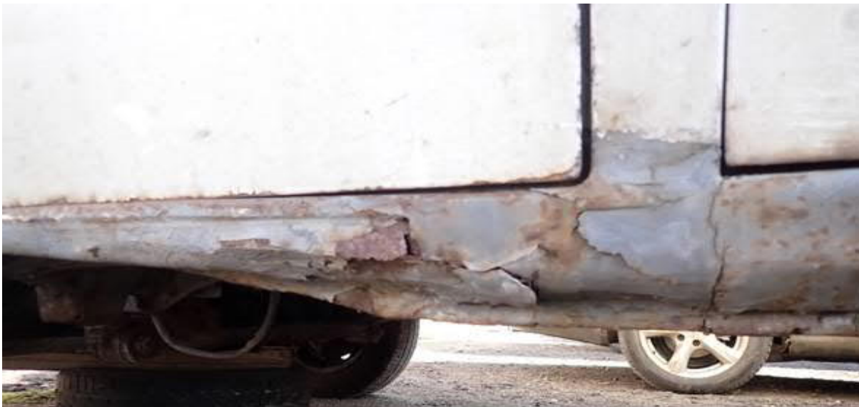
levý práh a sloupek B zkorodovány
