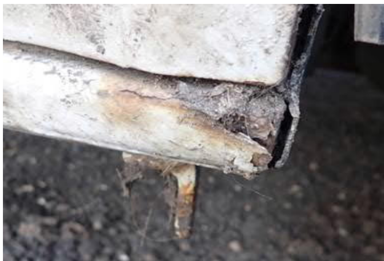
pravý práh zkorodován
