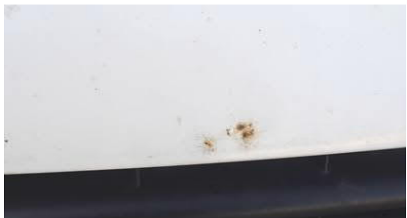
víko motoru zkorodováno
