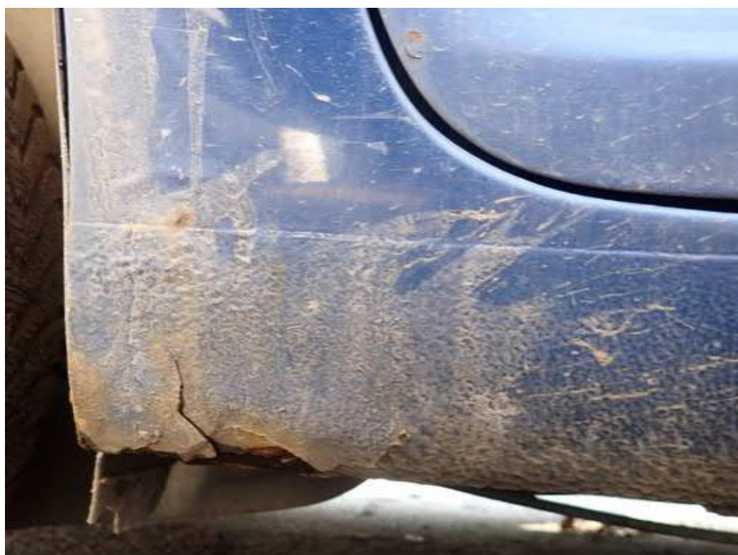
pravý práh a pravé přední dveře zkorodovány
