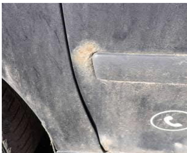
levé přední dveře zkorodovány
