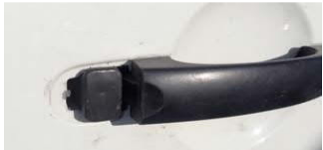
klika pravých předních dveří poškozena
