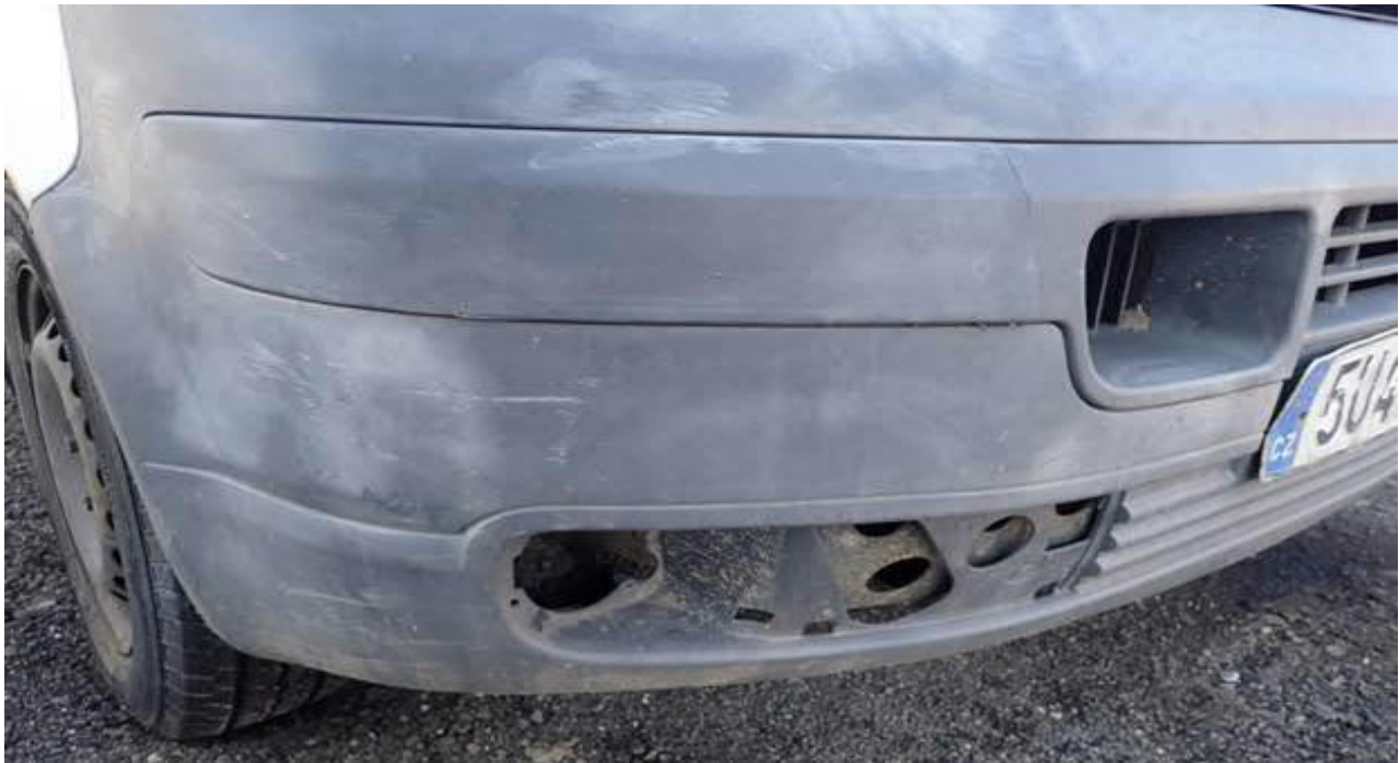
přední nárazník poškozen, chybí výplně
