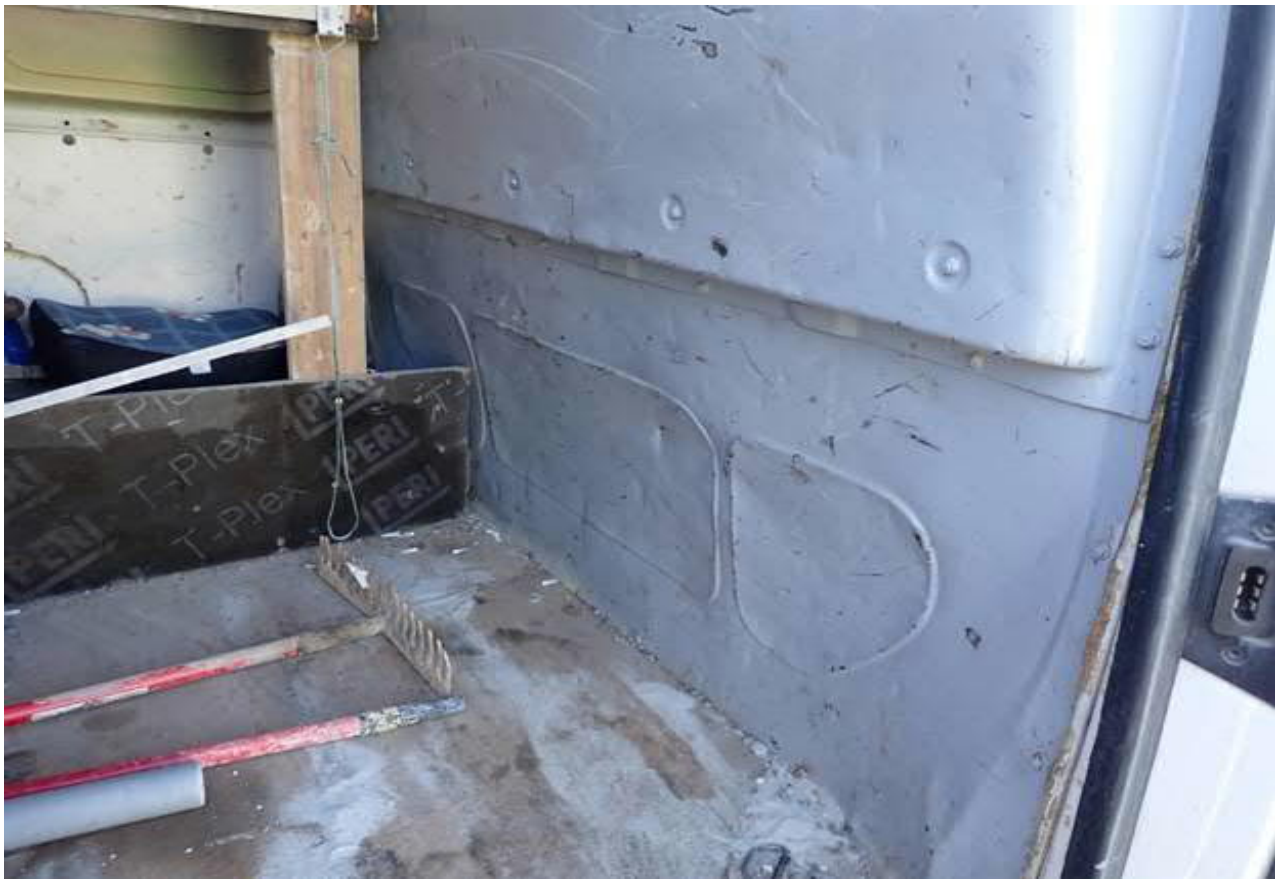
dělicí stěna ložného prostoru poškozena
