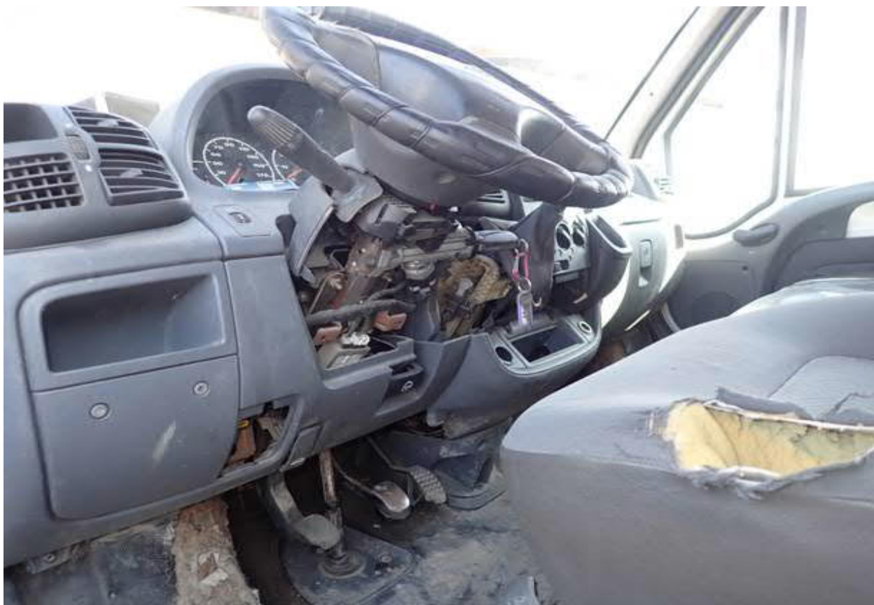
přístrojová deska nekompletní, el. spotřebiče a el. instalace přístrojové desky nutno opravit,
