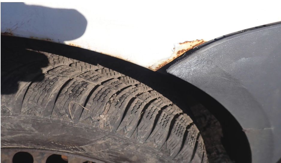
zkorodovaný pravý přední blatník a poškozen přední nárazník
