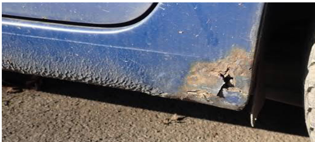
levý práh zkorodován
