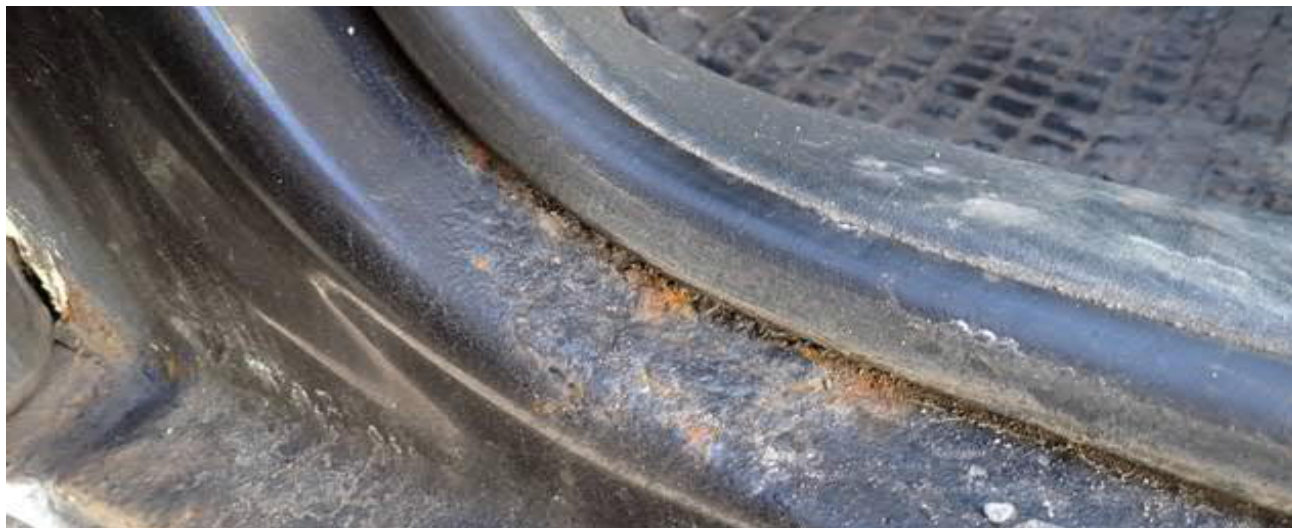
zkorodovaný levý práh
