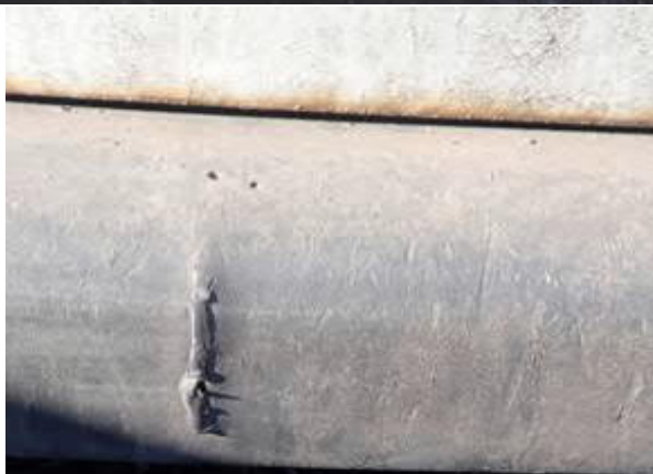
zadní nárazník poškozen, zadní dveře zkorodovány
