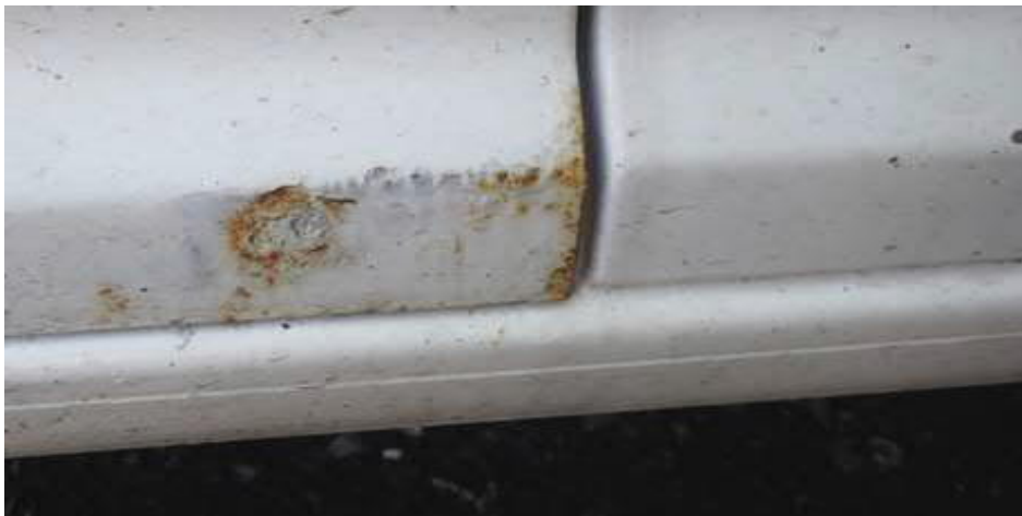
levé přední dveře zkorodovány
