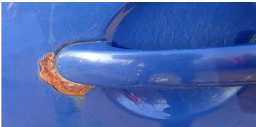
levé přední dveře u kliky zkorodovány
