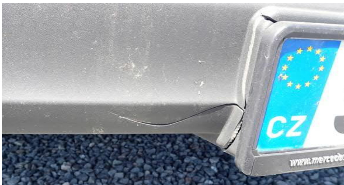
přední nárazník poškozen
