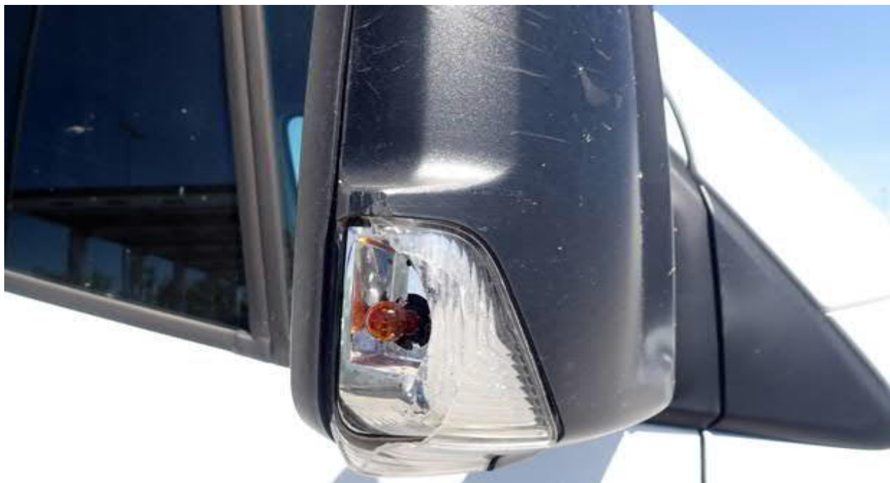
poškozen kryt a blikač pravého zrcátka
