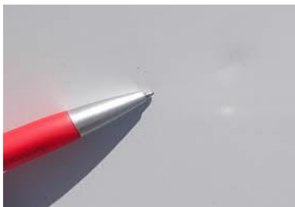
pravý bok skříně poškozen 1dm2
