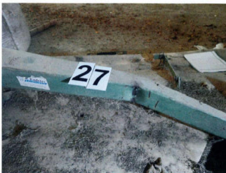
ST 27/25 Rotační žací stroj ŽTR 185, vrak, detail zlomeného rámu
