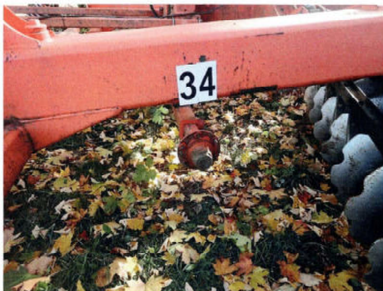
ST 34/25 Diskový podmítač HT 500 – detail chybějícího kola
